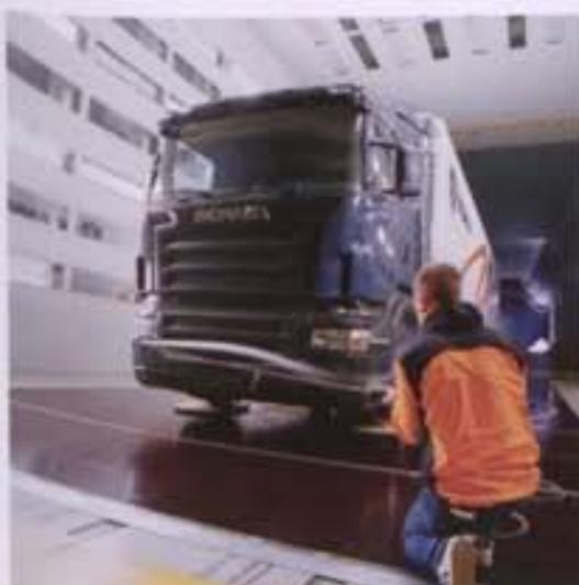
Im Windkanal werden verschiedene Außenbleche getestet, um die aerodynamische Wirkung zu verfeinern und den Kraftstoffverbrauch zu reduzieren.
